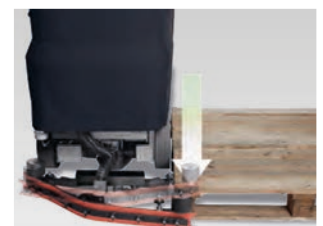
Reinigungsbürsten mit automatischem Einzug bei Stößen
