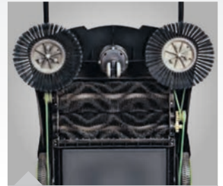
Abb. zeigt HKM 700 mit Tandem-Walzen-System
