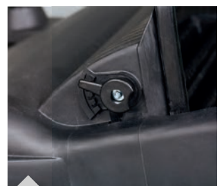
Einfache und werkzeuglose Höhenverstellung der Kehrwalze
