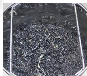
Edelstahlbehälter ist unempfindlich gegenüber scharfkantigen Metallspänen
